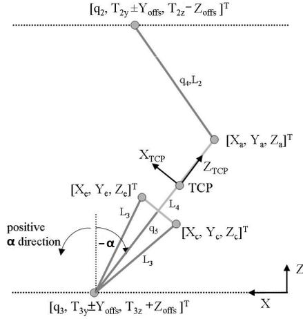
Figure 3: Kinematic parameters in  $XZ$ -plane.
