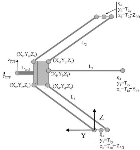
Figure 4: Kinematic parameters in  $YZ$ -plane.
